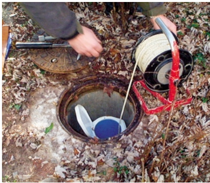
Bild 2: Prüfen des Wasserstands in einer Grundwassermessstelle Quelle: Amt für Umweltschutz Stadt Stuttgart
